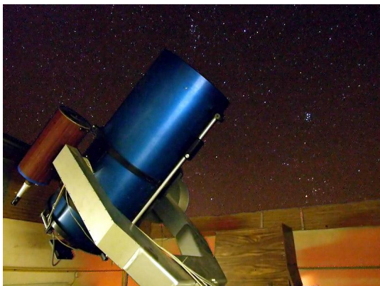
11. ábra. A bajai 51 cm-es Ritchey-Chrétien távcső. Forrás: www.bajaobs.hu .
