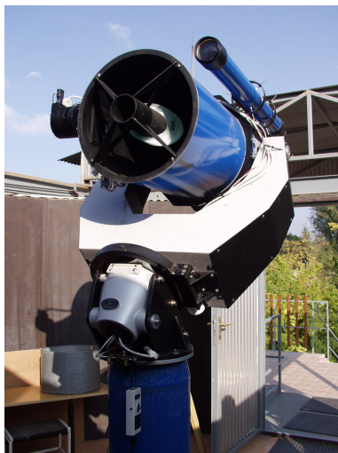
7. ábra. A szegedi 40 cm-es Newton-szerelésű távcső. Forrás: www.astro.u-szeged.hu .
