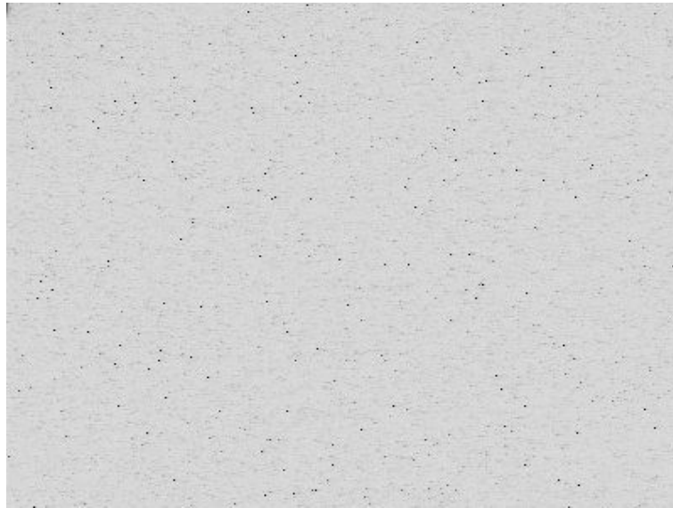
7. ábra. Master dark-kép. Megfigyelhető a forró pixelek okozta szemcsésség. (forrás: www.astrosurf.com )
