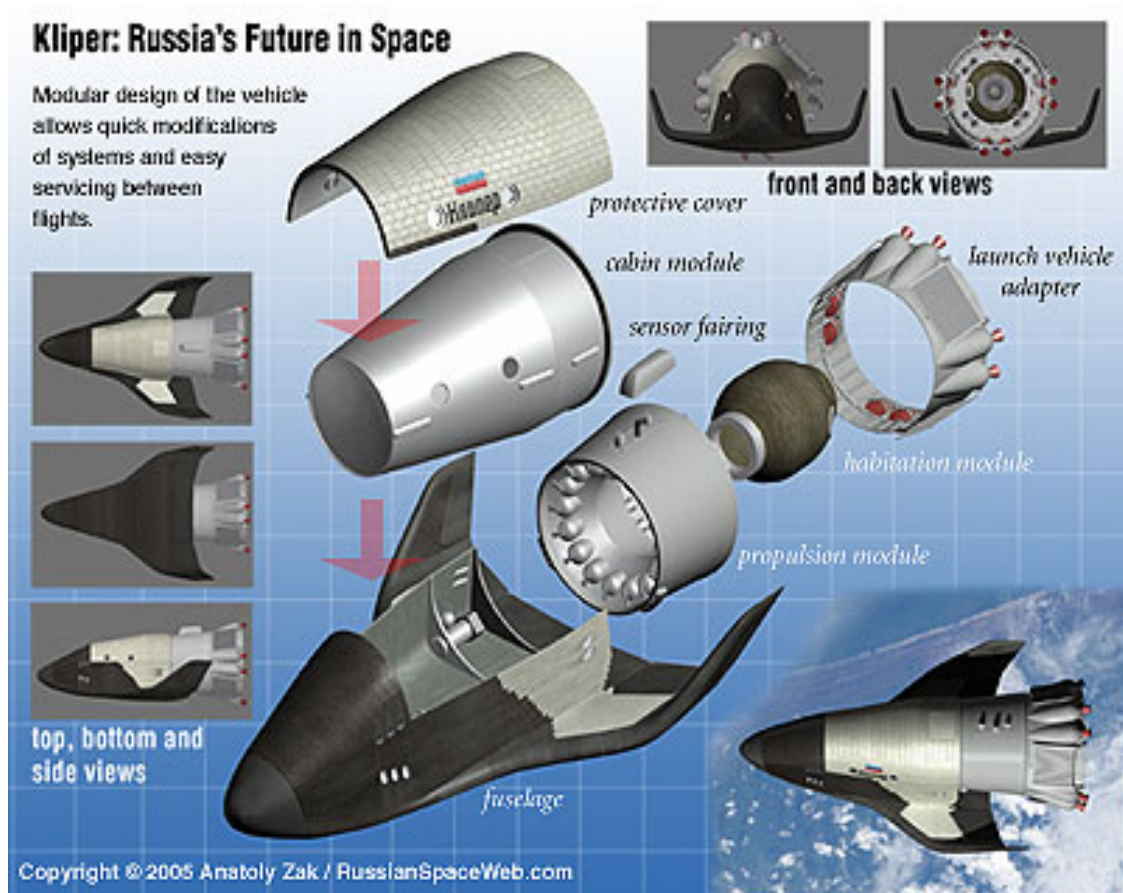
11. ábra: A 2006-os változat szerkezeti felépítése.
