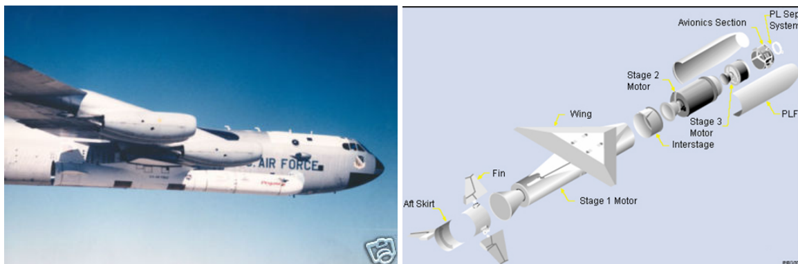
12. ábra: A Pegasus rakéta B-52 hordozógépre függesztve, valamint a rakéta szerkezeti rajza.
