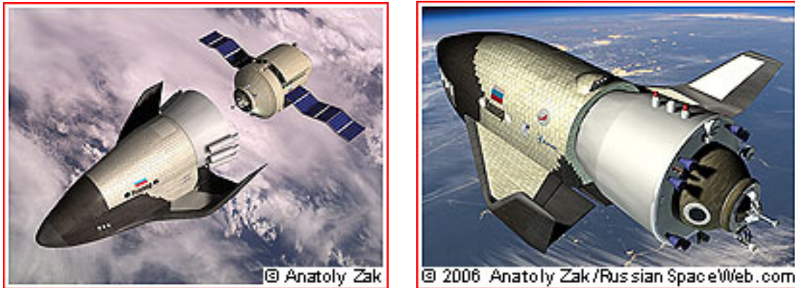
10. ábra: A 2005-ös változat a Parom orbitális modulal, és a 2006-os változat, leváló orbitális kabinnal.
