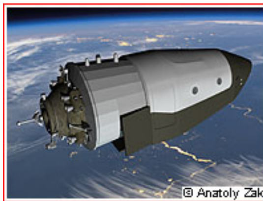
9. ábra: Lifting Body változat, hidrogén cellás energiaforrással, 2004 november.
