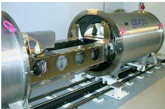
25. ábra. A HARPS – a vákuum alatt levő tartály kinyitva.
