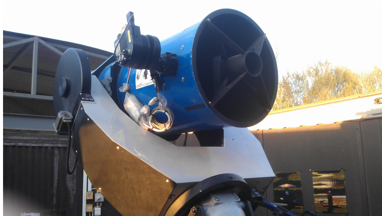
8. ábra. A szegedi 40 cm-es távcső SBIG ST-9 CCD-kamerával.
