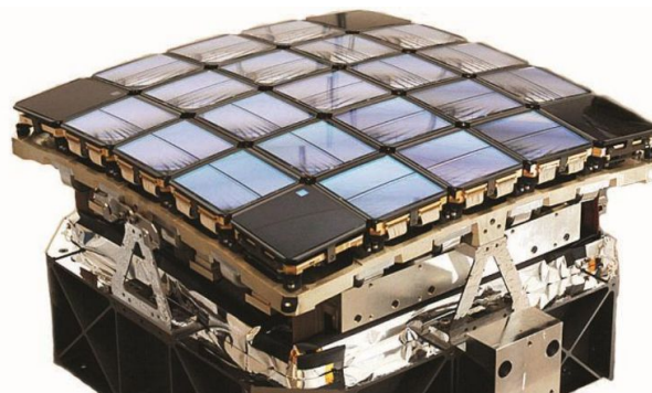
2. ábra. A Kepler-űrtávcső CCD-detektora.
