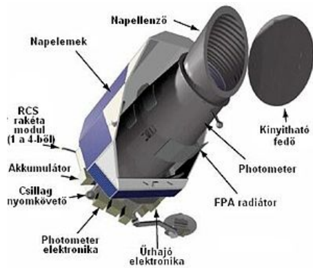
3. ábra. A Kepler űrtávcső felépítése (Link4).
